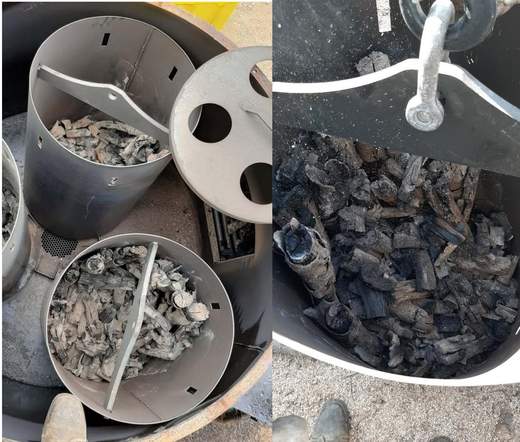
Con il sistema di carbonizzazione diretta si è rilevato un tempo di carbonizzazione di circa 12 ore con produttività del sistema variabile dal 21 al 24% ed una necessità di materiale legnoso per la cottura prossima ai 95 kg umidità al 30%.
