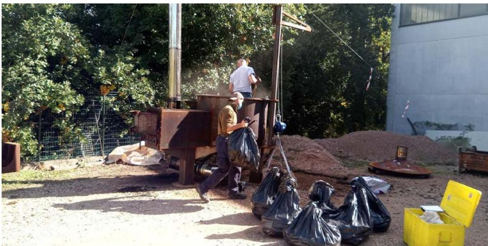
Al termine della prima tornata di prova è stato estratto il materiale e fatta una prima valutazione della produzione e del processo sulla base dei dati di monitoraggio posti in essere durante l'intero processo di carbonizzazione.
